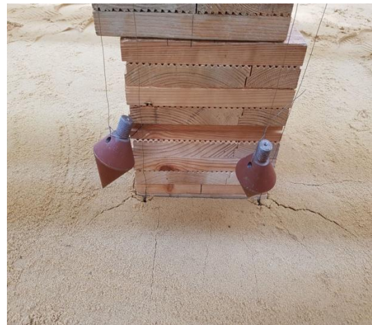
Рис.6 Образование трещин под конец испытания
